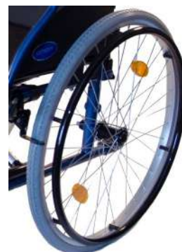
Catadióptricos. Llanta, aro y radios de acero
